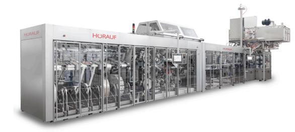
Dosenherstellungsanlage eine aseptische Füllmaschine zum Befüllen und Verschließen der Packung mit nicht-karbonisierten, flüssigen Getränken (z.B. Cocktails, Smoothies, Wellness-Getränke). Die Sterilisation der Verpackung fällt unter die höchste Sterilisationskategorie, sodass auch low-acid Produkte (z.B. Milch und Milchmixgetränke) kaltaseptisch mit einem Mindesthaltbarkeitsdatum MHD von bis zu 12 Monaten abgefüllt werden können.
